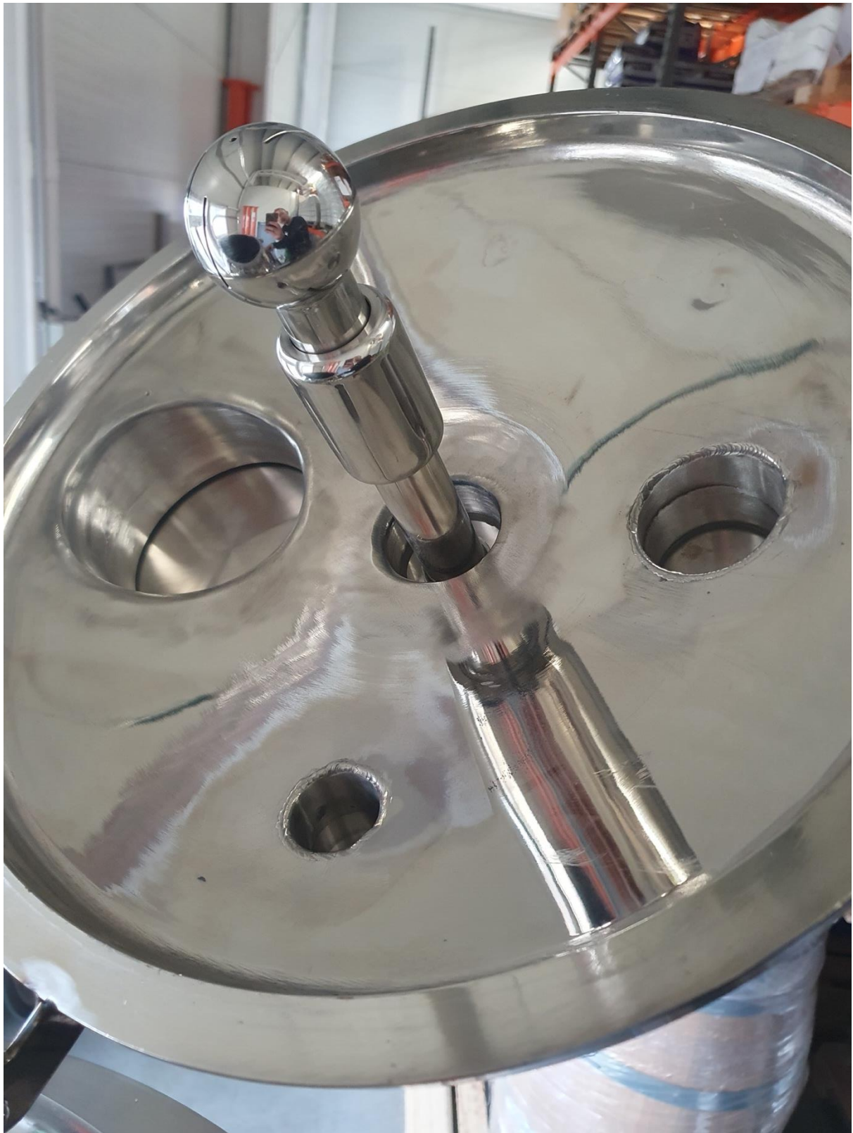
Detail vrchního klobouku s CIP hlavicí, která je připravena na prodlouženém potrubí.
