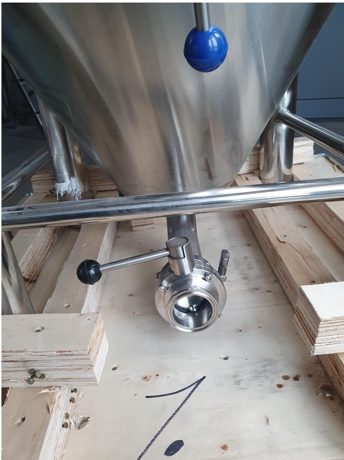
Detail spodního výpustného ventilu v zavřené poloze.
