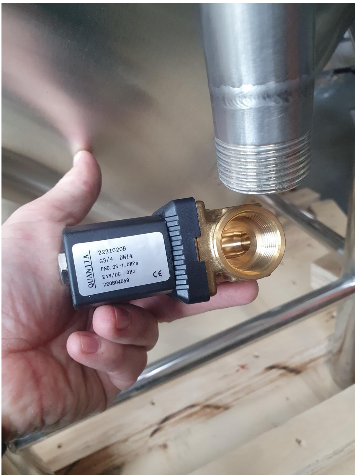
Solanoidní ventil s vnitřním závitem G3/4. Napojení chlazení má venkovní závit o rozměru 1''
