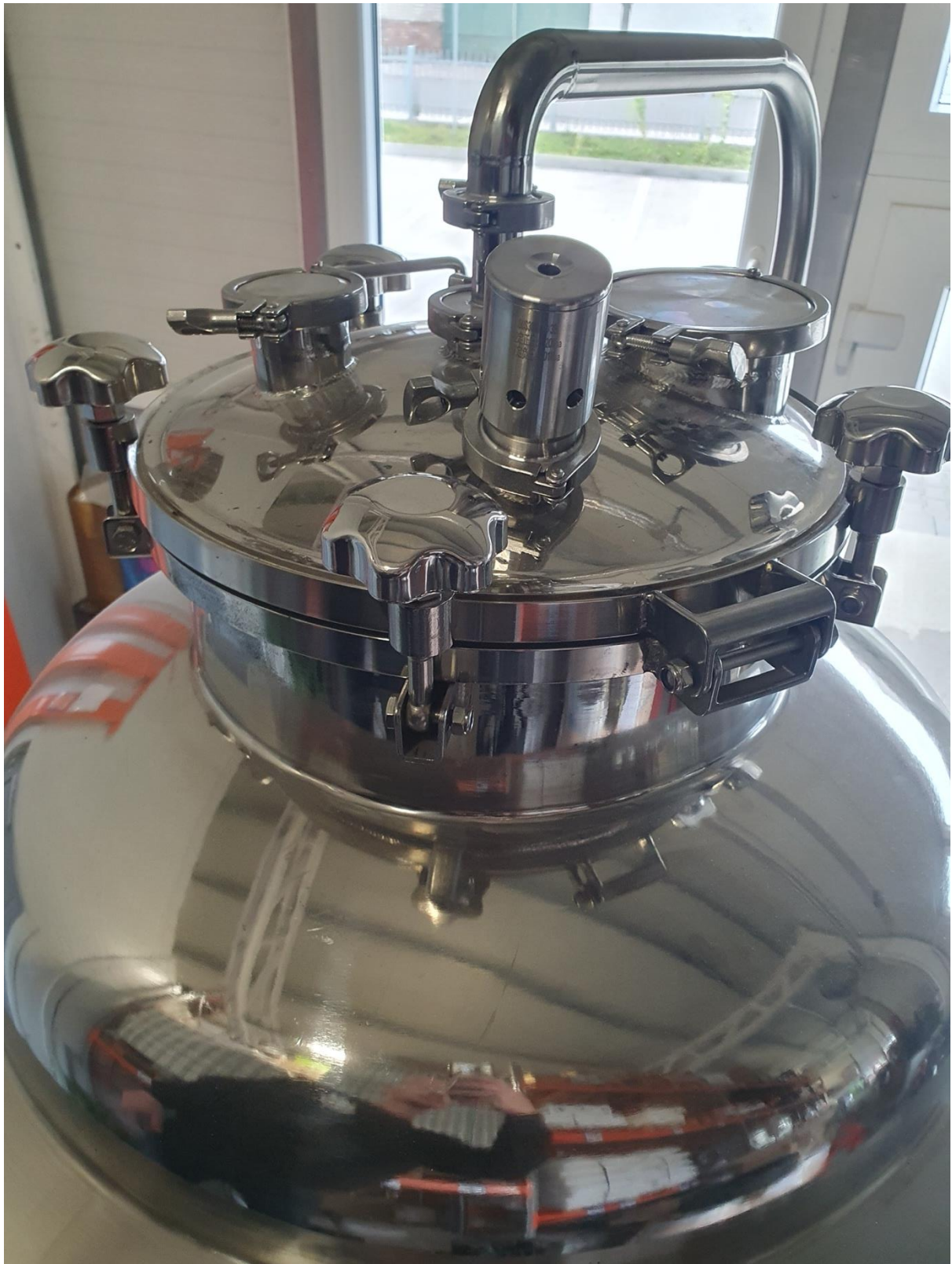
Detail vrchního klobouku CK tanku.
